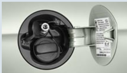
Ett gemensamt tanklock för bensin/fordonsgas.
